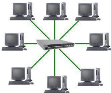
**Estrella Extendida:** Enlaza las estrellas conectadas a los switches de estas a un switch central.
