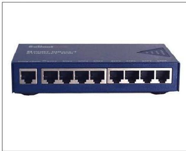
**Switch.-** Es un dispositivo digital de lógica de interconexión de redes de computadores que opera en la capa 2 (nivel de enlace de datos) del modelo OSI. Su función es interconectar dos o más segmentos de red, de manera similar a los puentes (bridges), pasando datos de un segmento a otro de acuerdo con la dirección MAC de destino de las tramas en la red.
