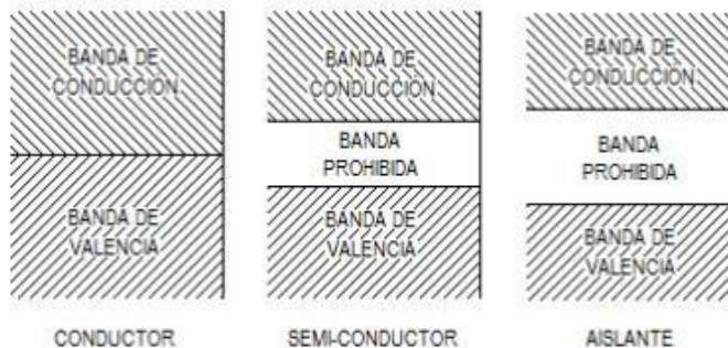
Fig. 1 Los materiales, de acuerdo a su conductividad, pueden clasificarse en tres categorías principales: conductores, semiconductores y aislantes.
