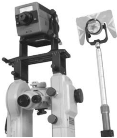
Figura 2-37. Distanciómetro Mini-Red-II Sokkia, montado sobre teodolito, mide hasta 800 m con rayo infrarrojo y prisma reflector.
