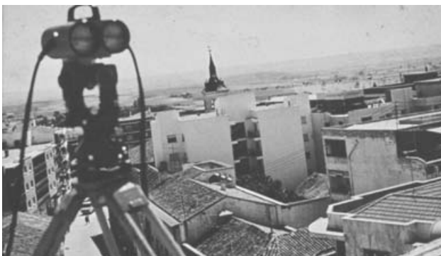
Figura 2-38. Distanciómetro electrónico sobre teodolito (Leica) equivalente a una estación total primitiva.
