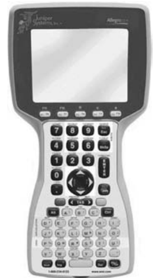
Figura 2-42. Libreta electrónica de campo para pasar luego a la computadora los datos de campo en forma directa.
