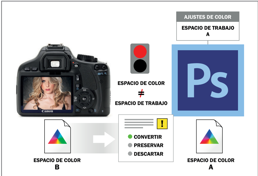
Figura 30. Photoshop utiliza su motor de color para convertir el espacio de color (B) en el espacio de color (A), sin modificar la apariencia original de la imagen.
