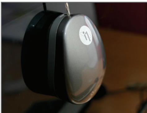
Figura 18. Calibración de un monitor LCD con un colorímetro i1 Display 2 de X-Rite. La calibración y generación de un perfil debería hacerse cada dos meses aproximadamente.
