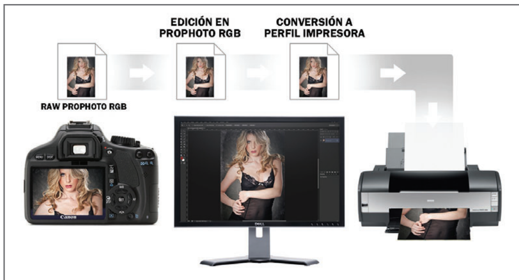
Figura 24. El método de compilación tardía busca editar en el espacio más grande para, finalmente, convertirlo al espacio de color compatible con el dispositivo de publicación; en el caso del ejemplo, al perfil de color de la impresora.
