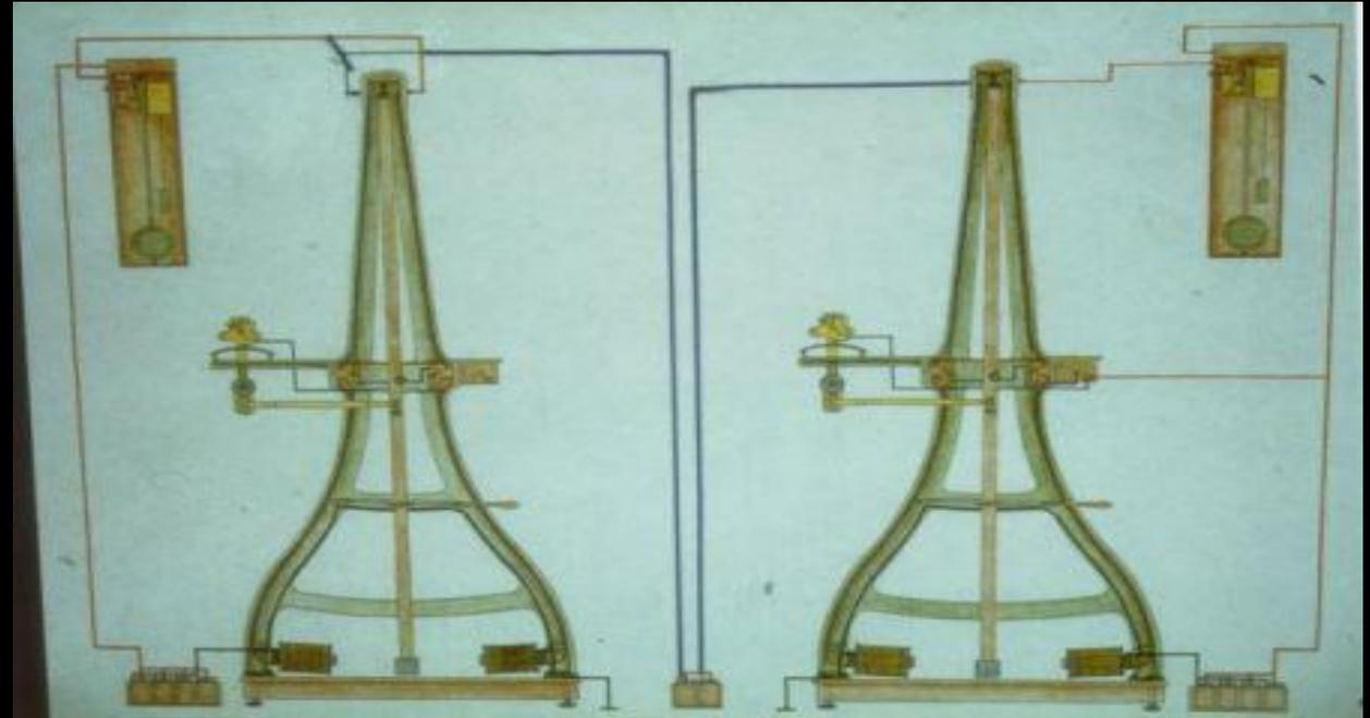
La puntina metallica del trasmittente esplora il documento originale scorrendo su linee parallele, e invia messaggi al ricevente attraverso la linea telegrafica. La puntina del ricevente percorre un foglio trattato chimicamente e annerisce la carta a seconda del segnale ricevuto. Due grossi pendoli garantiscono la sincronia dei due apparati.
