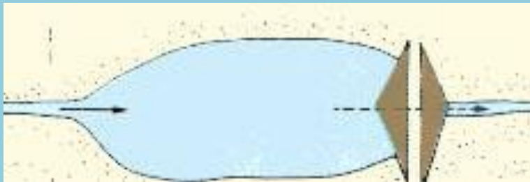
Estanque de presa sin canal de derivación
