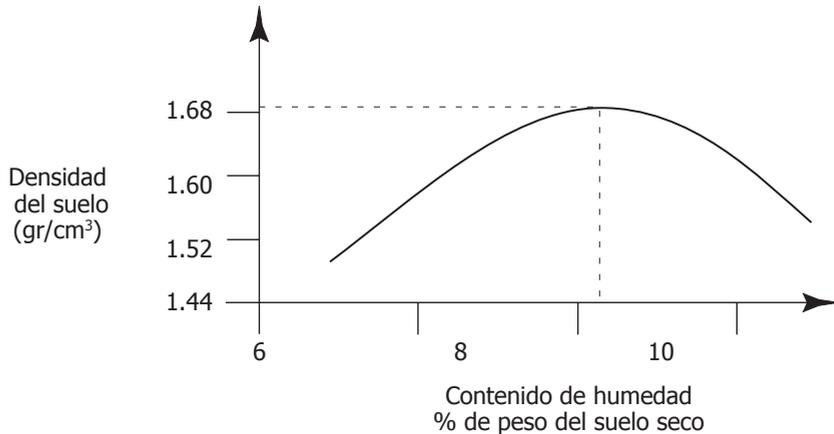
La especificación de compactación para un relleno debe entenderse así: un requerimiento de compactación de 95% significa que el material, ya compactado, debe tener una densidad mínima del 95% del peso volumétrico máximo del terreno, el cual como ya se mencionó se obtiene cuando el material tiene un contenido óptimo de humedad. En la tabla 4 se presentan los requisitos de algunas compactaciones en función de su densidad en seco.
