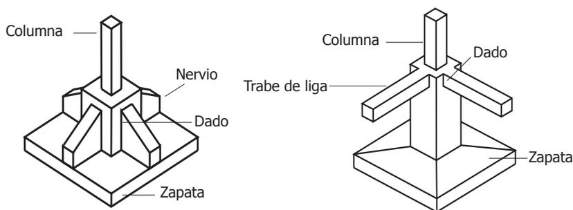
Las zapatas aisladas pueden conectarse estructuralmente entre sí, a través de traves de liga. Estas soportarán los esfuerzos de flexión producidos por la reacción del terreno, además de funcionar como elementos rigidizantes y de liga de la subestructura.
