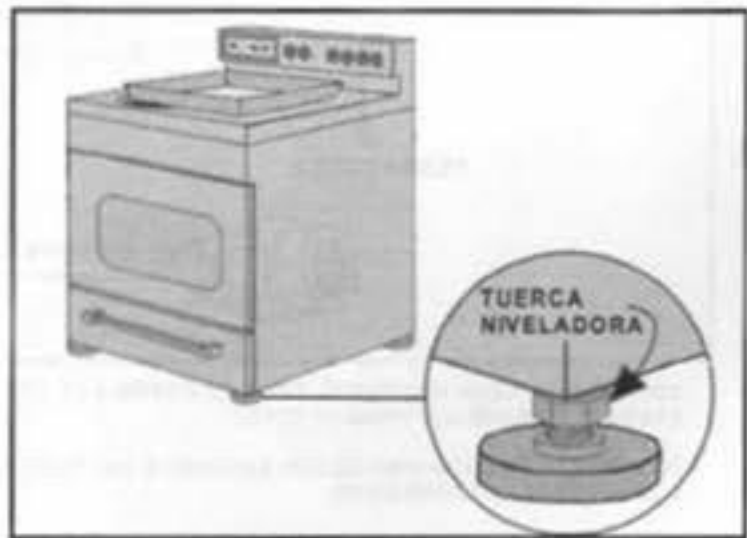
6 SE COLOCA LA ESTUFA EN LA POSICIÓN FINAL Y SE NIVELA CON LOS NIVELADORES O AJUSTADORES DE PATAS.
