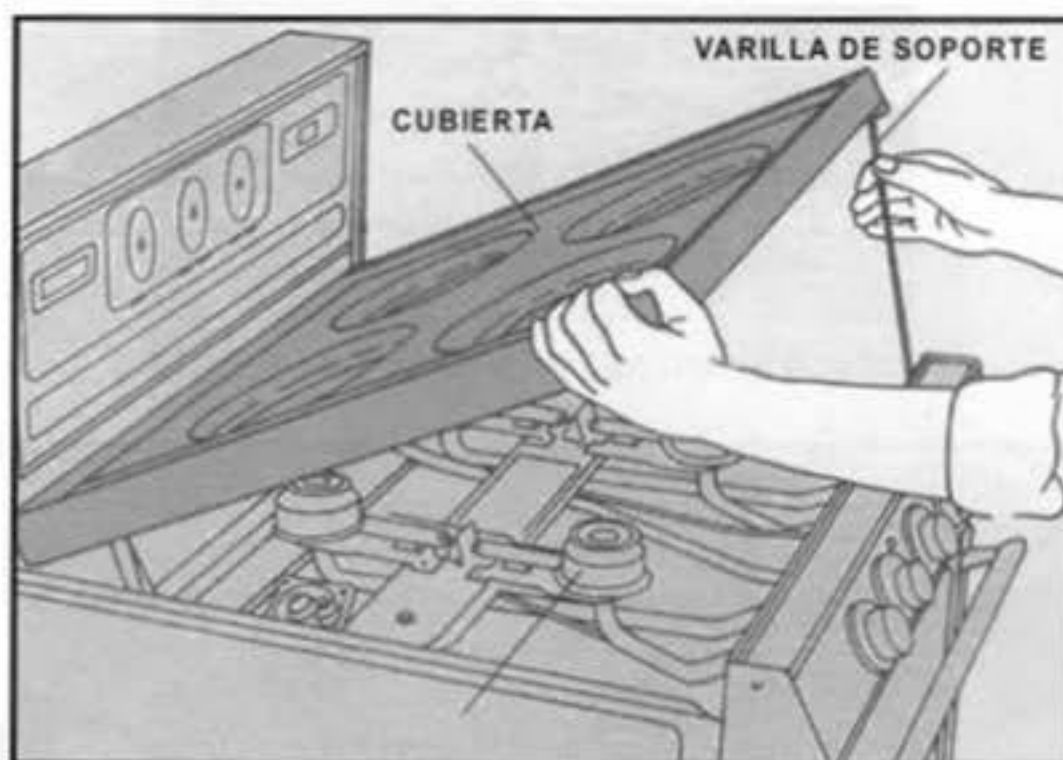
FORMA DE ACCESO A LOS QUEMADORES Y PILOTOS EN UNA ESTUFA DE GAS
