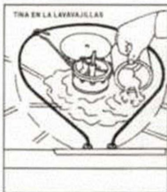
2.- SE VACÍAN LOS ELECTRODOMÉSTICOS, EXTRAYENDO EL AGUA QUE CONTENGAN
