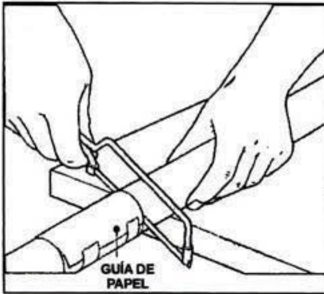
1.- COLOCAR LA CINTA DE PAPEL ALREDEDOR DEL TUBO Y CORTAR
