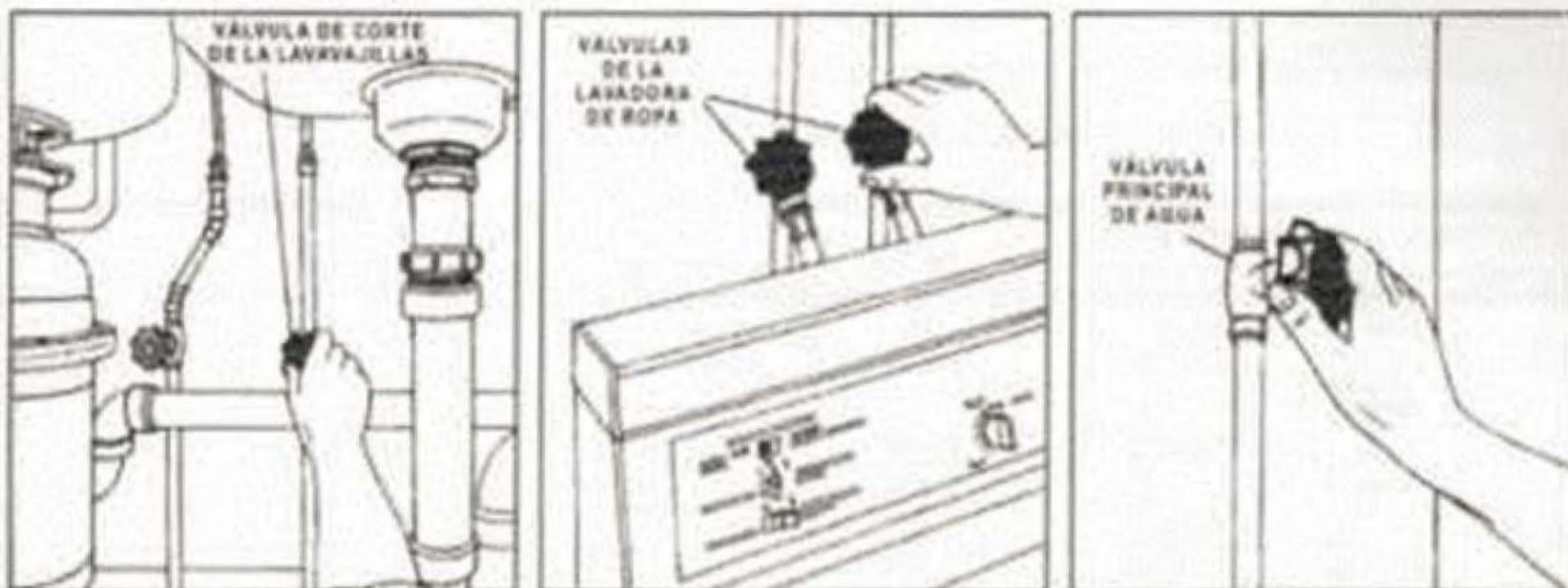
1.- SE CIERRA O SE CORTA EL SUMINISTRO DE AGUA
