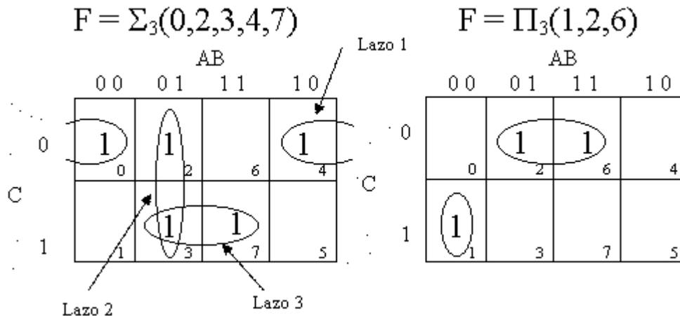
La función simplificada tendrá tres sumandos en un caso y dos productos en el otro. Si nos fijamos en el mapa correspondiente a la suma de productos, observamos que en el lazo 1 cambia la variable A (en la celda 0 es negada y en la 4 directa), en el lazo 2 es la C y en el lazo 3 vuelve a ser A. por lo tanto, la ecuación simplificada es:
