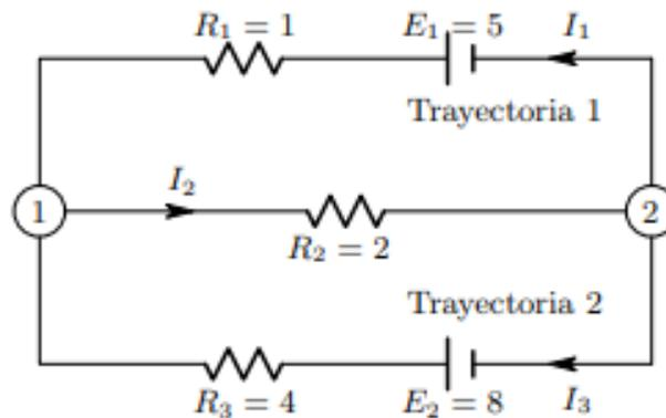
Figura 1.5: Red eléctrica con dos trayectorias.
