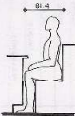
1.14.(B) Espacio mínimo requerido entre la superficie del asiento y un obstáculo a la altura de los muslos.
