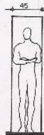
1.21.(B) Claros mínimos para diseñar cajones (espacios de trabajo).
