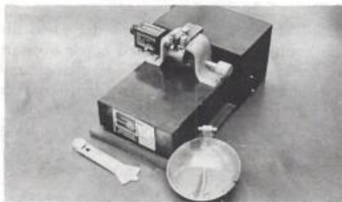
Figura VI-4. Detalles de la copa de Casagrande.
