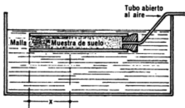
Figura IX-12. Esquema de la disposición de la muestra en la prueba horizontal de capilaridad.
