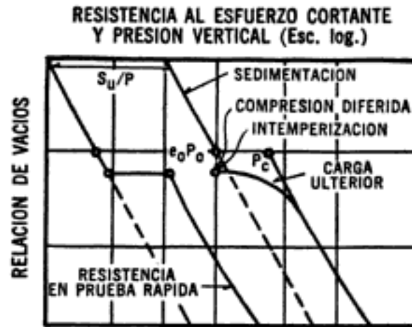
Figura XII-i.1. Efecto del intercambio catiónico en la compresibilidad y en la resistencia al esfuerzo cortante de arcillas normalmente consolidadas.
