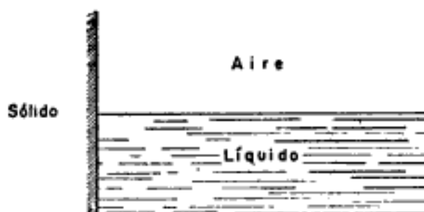
Figura VIII-2. Contacto de un líquido y su pared, sin tomar en cuenta la formación de meniscos.
