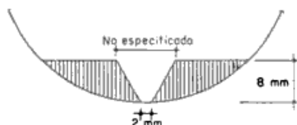
Figura VI-3. Esquema del suelo colocado en la cápsula y ranurado para determinar su límite líquido según Atterberg.
