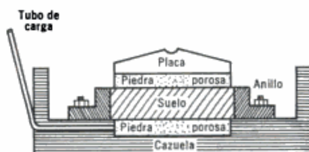
Figura X-2. Detalle de la colocación de la muestra en el consolidómetro de anillo fijo.
