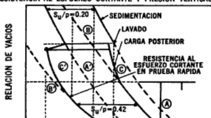
Figura XII-g.1. Efecto de lavado sobre la compresibilidad y la resistencia al esfuerzo cortante de las arcillas marinas.
