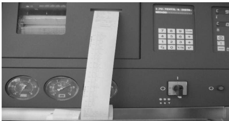
Figura 7-14. Tablero de control del esterilizador de vapor.
