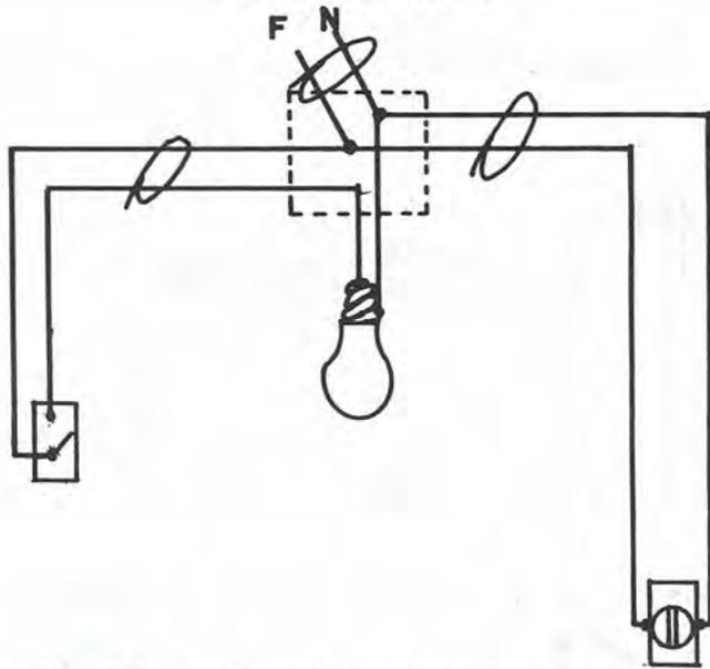
Conexión de una lámpara incandescente, controlada con un apagador sencillo y un contacto sencillo al otro extremo, indicando llegada de la línea por detrás de la caja de conexión de la que se encuentra suspendida la lámpara.
