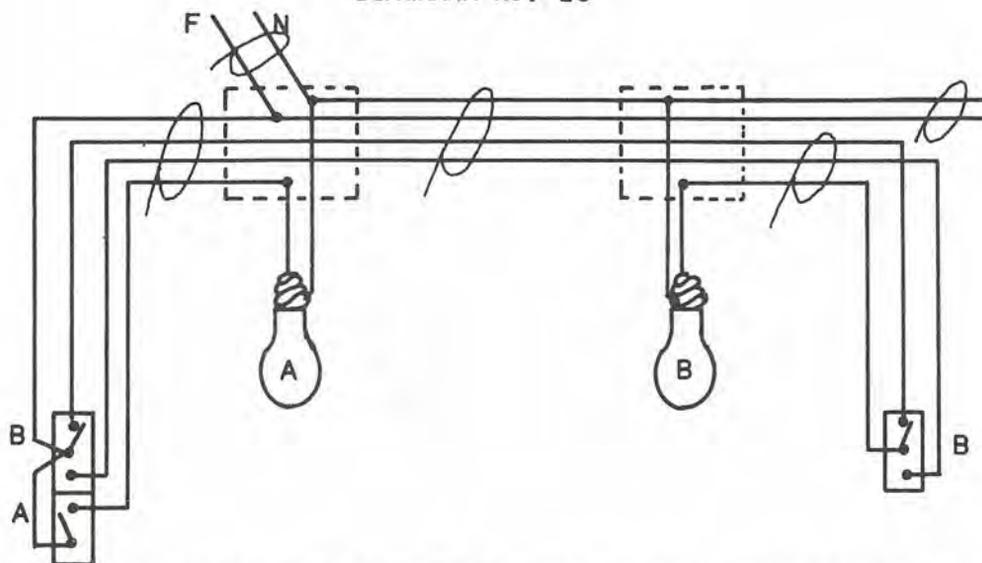
Conexión de dos lámparas incandescentes, controlada la "B" con dos apagadores de "3 vías" o escalera y la "A" con un apagador sencillo, indicando llegada y continuación de la línea.
