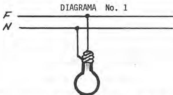
La fase siempre debe ir a la parte alta del casquillo (punto central) y el neutro al casquillo, con lo anterior se evita que al aflojar la lámpara, la persona toque accidentalmente el hilo de corriente al hacer contacto con la parte roscada siendo ello peligroso, máxime si se está sobre parte húmeda o buena conductora de la electricidad.
