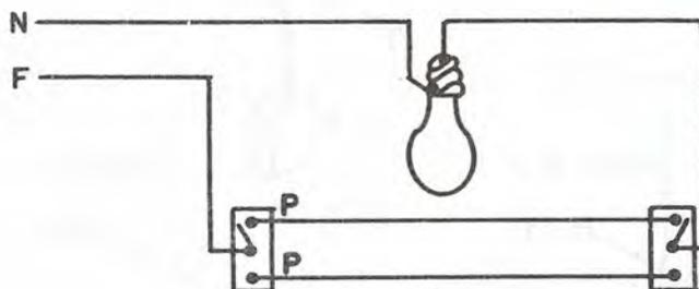
Conexión elemental de una lámpara incandescente, controlada con dos apagadores de "3 vías" o de escalera, utilizando --- puentes comunes.
