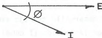
Bajo las anteriores condiciones, en este caso la P. aparente difiere de la P. útil.
