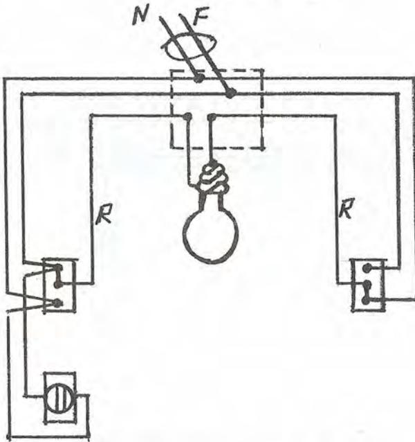
Solución al problema planteado en el diagrama No. 12, pero conectando los apagadores de 3 vías o de escalera en corto-circuito.
