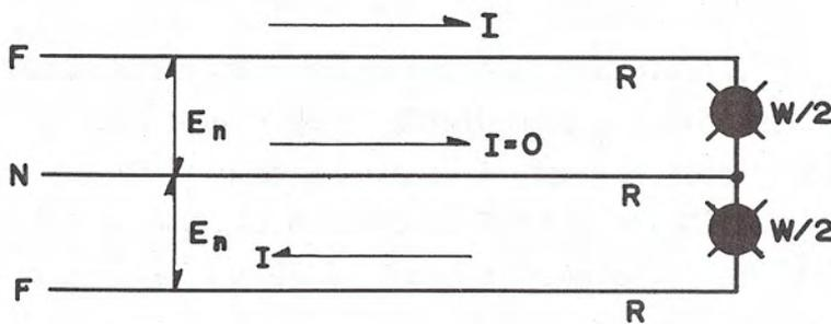
Si se observa detenidamente al diagrama anterior, realmente se trata de dos sistemas monofásicos a dos hilos.
