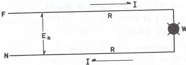
$W = E I$  --- Watts; esta fórmula en corriente alterna -- (C.A.) sólo nos da la potencia aparente o de línea y la potencia real siempre y cuando se tenga en el circuito carga 100% resistiva.
