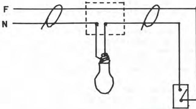
Conexión de una lámpara incandescente, controlada con un -
