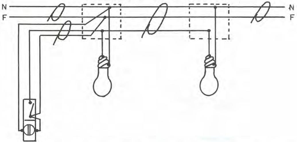
Conexión de dos lámparas incandescentes, controladas con un apagador sencillo localizado junto a un contacto también sencillo, indicando llegada y continuación de la línea.
