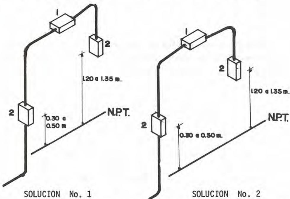
1 Cajas de conexión redondas o cajas de conexión cuadradas de 13 mm. con tapa.
