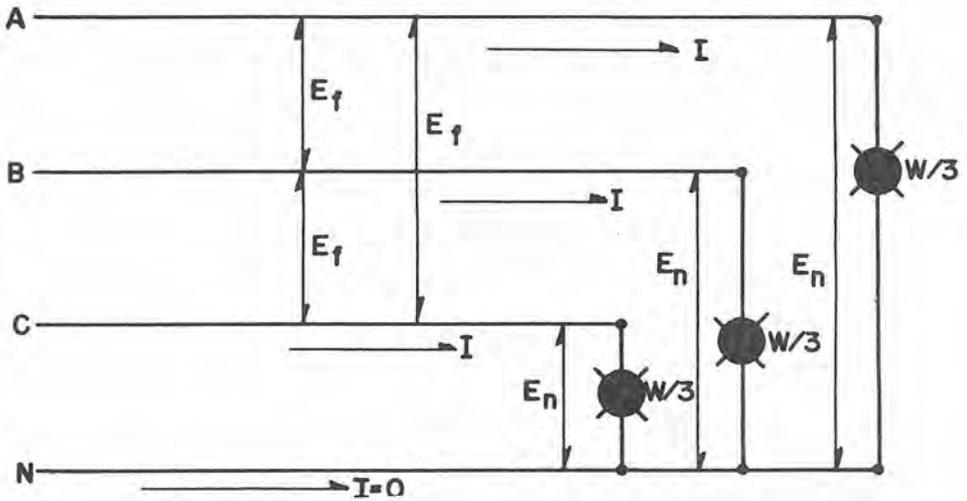
Tratándose de un sistema trifásico a cuatro hilos (3 $\phi$  - 4h) que se considera 100% balanceado, en el neutro se toma una intensidad de corriente igual con  $I_n = 0$ , además, de la figura se desprende que son en realidad 3 sistemas monofásicos a dos hilos.
