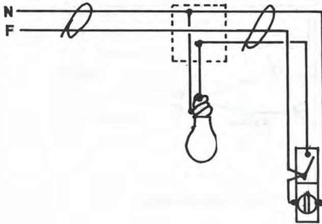
Conexión de una lámpara incandescente, controlada con un -
