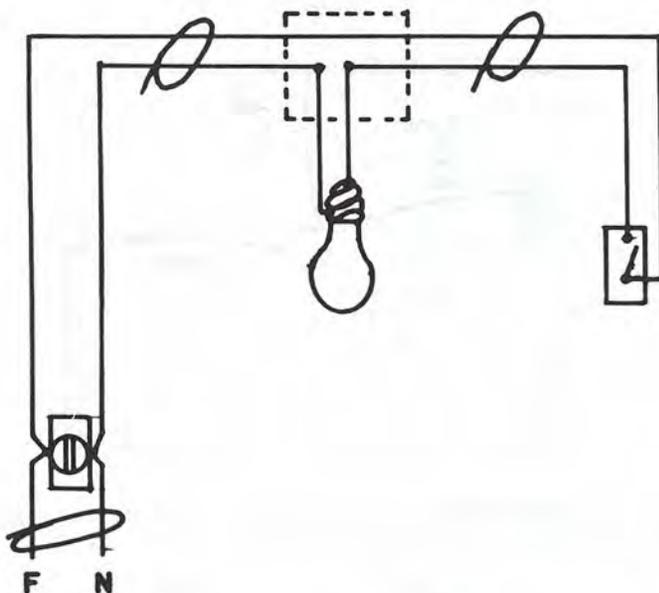
Conexión de una lámpara incandescente, controlada con un apagador sencillo y un contacto sencillo por donde llega a través del piso la línea.
