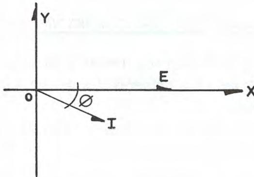
La corriente que desarrolla trabajo efectivo, es solamente la que está en fase con la tensión ( $I \cos\phi$ ) y la proyectada sobre el eje de las YY ( $\text{sen}\phi$ ), es la que provee al campo inductor.
