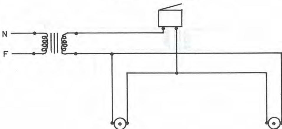
Conexión de un timbre, controlado con dos botones.
