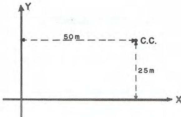
Una vez localizado el centro de carga, se juzgará si las condiciones del local y tipo de trabajo permiten la colocación del equipo (tablero de distribución para alimentación de las cargas parciales) en este punto, si ello no es posible, el centro de carga se corre hacia uno de los muros que lógicamente en este caso es el que se ha tomado como eje de las XX.
