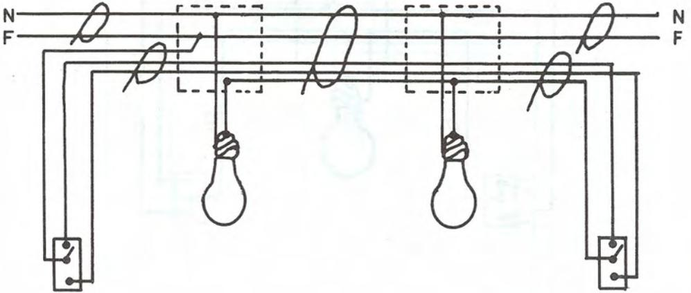
Conexión de dos lámparas incandescentes, controladas con dos apagadores de "3 vías" o de escalera con indicación de llegada y continuación de línea.
