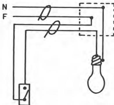
Conexión de una lámpara incandescente, controlada con un -
