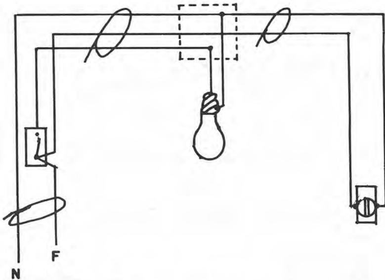
Conexión de una lámpara incandescente, controlada por un-
