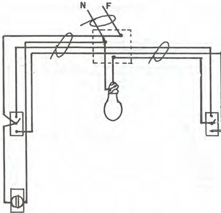
Conexión de un contacto sencillo y una lámpara incandescente, controlada con dos apagadores de "3 vías" o de escalera, indicando llegada de la línea por detrás de la caja de conexión - de la que se encuentra suspendida la lámpara incandescente.
