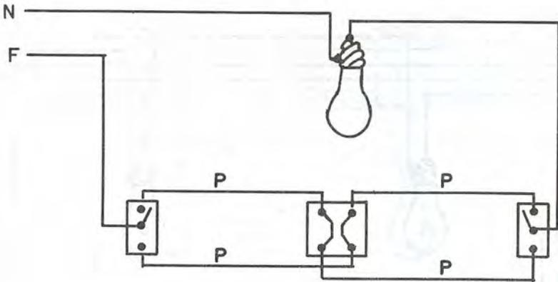
Conexión elemental de una lámpara incandescente, controlada con dos apagadores de "3 vías" y uno de "4 vías" o de paso.
