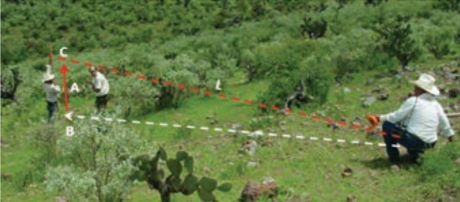
Figura 31. Medición de pendiente con nivel de hilo.
