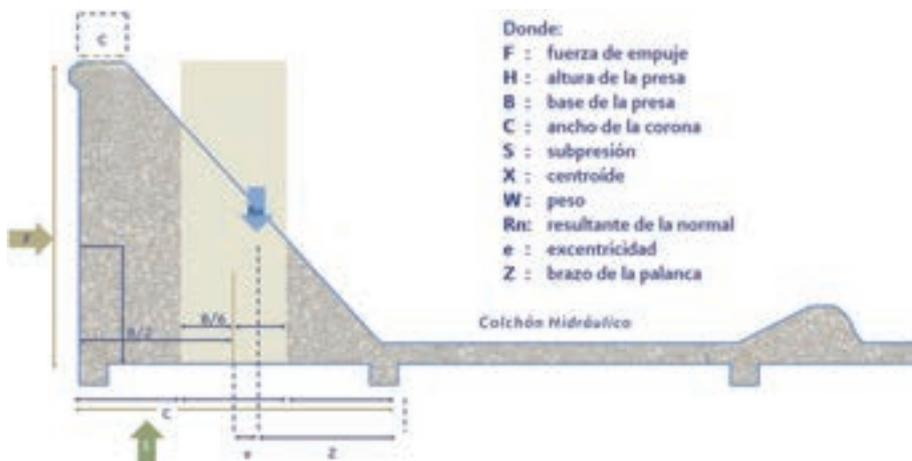
Figura 82. Factores a considerar en el diseño de una presa de mampostería.
