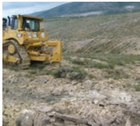
Foto 65. Roturación con bulldozer que permite un corte profundo.
