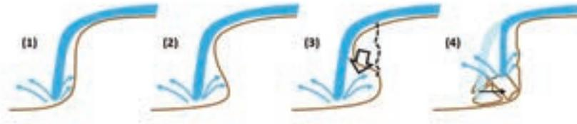
Figura 5. Erosión remontante.
