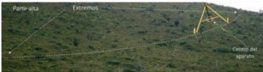
Figura 23. Centro del aparato "A" para una segunda marca.
