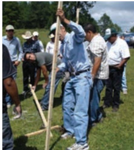
Foto 34. Construcción del nivel de manguera.
