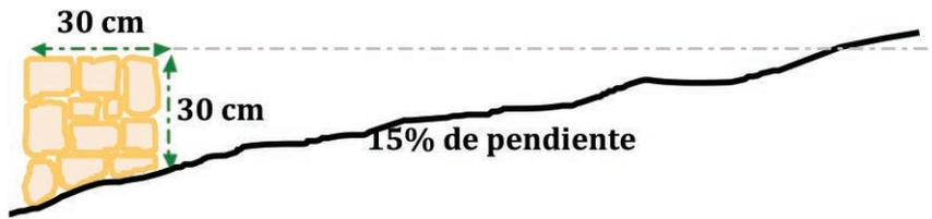
Figura 92. Dimensiones y área de captación de una barrera de piedra acomodada.
