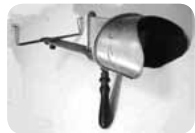
Figura 3.7 Estereoscopio empleado en el siglo XIX para el estudio de la visión en tercera dimensión.
