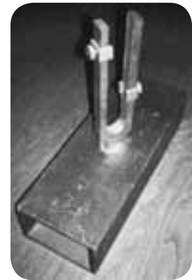
Figura 3.3 Diapasón ajustable utilizado para estudios de percepción auditiva.
