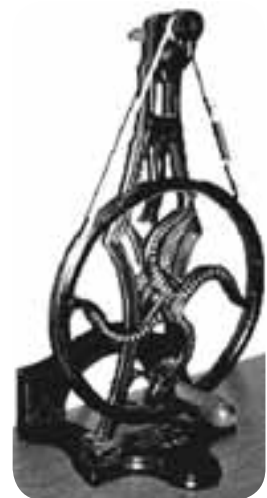
Figura 3.10 Mezclador de colores que se empleó en el estudio de la percepción de los mismos.
