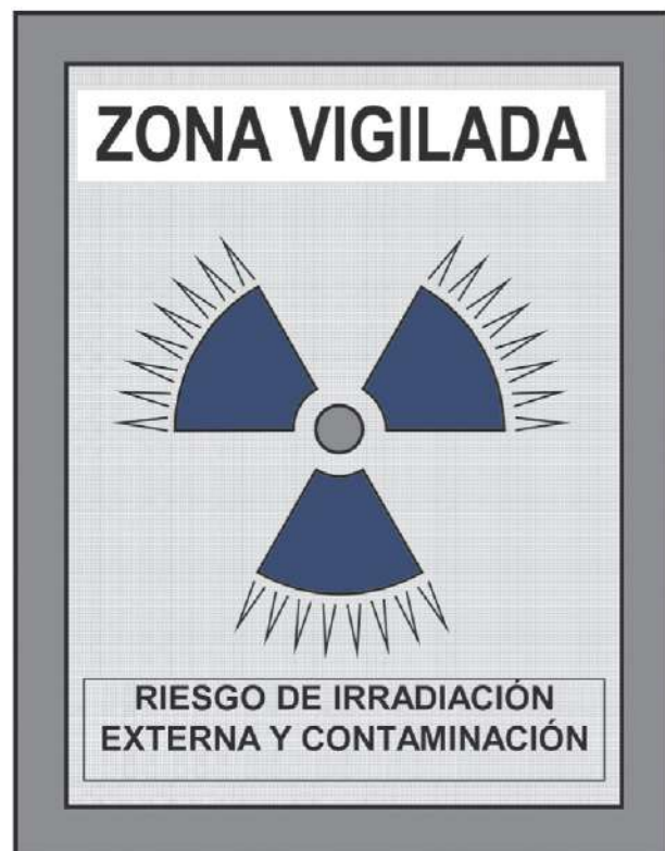
FIGURA 23-3 Trébol radiológico de señalización de zonas. Si denominamos R al radio del círculo central, el radio interno de las tres aspas debe ser 1,5 R y el externo 5 R. Asimismo, R será la anchura del marco exterior del trébol.
