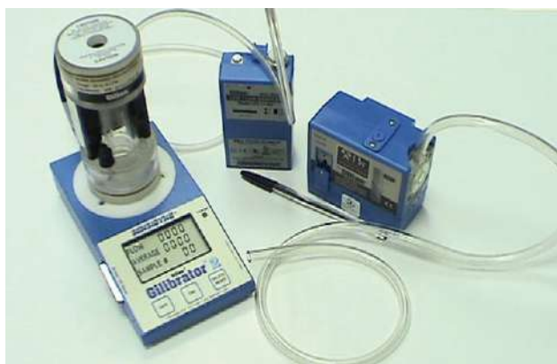
FIGURA 25-5 Bombas de captación y medidor de caudal.
