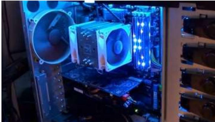
**Gabinete** – No es un dispositivo electrónico, pero sí una parte del computador, mediante la cual se da soporte a los componentes internos del PC, además de ofrecer una protección adicional.
