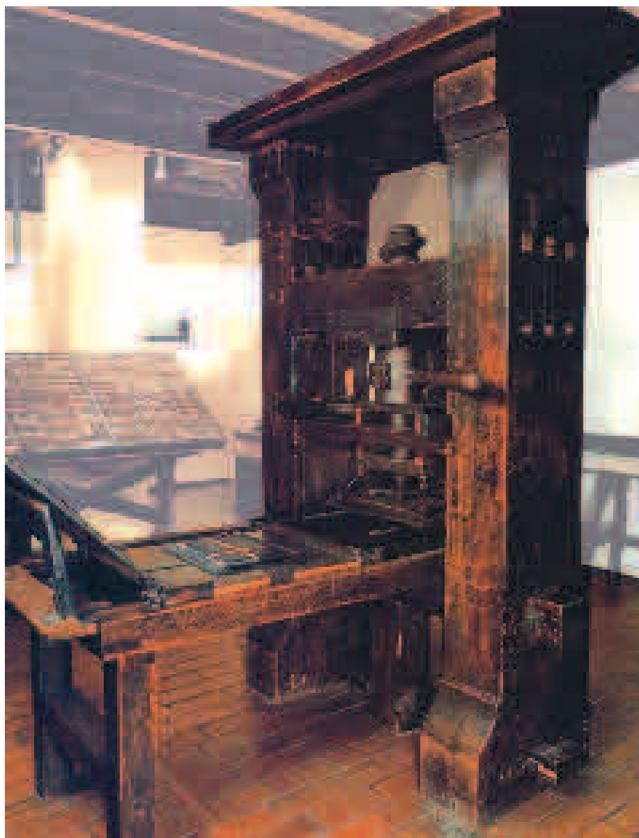
Figura 3-1. La prensa de Gutenberg fue una adaptación del tórculo romano y de las prensas de uvas empleadas a orillas del Rin.
