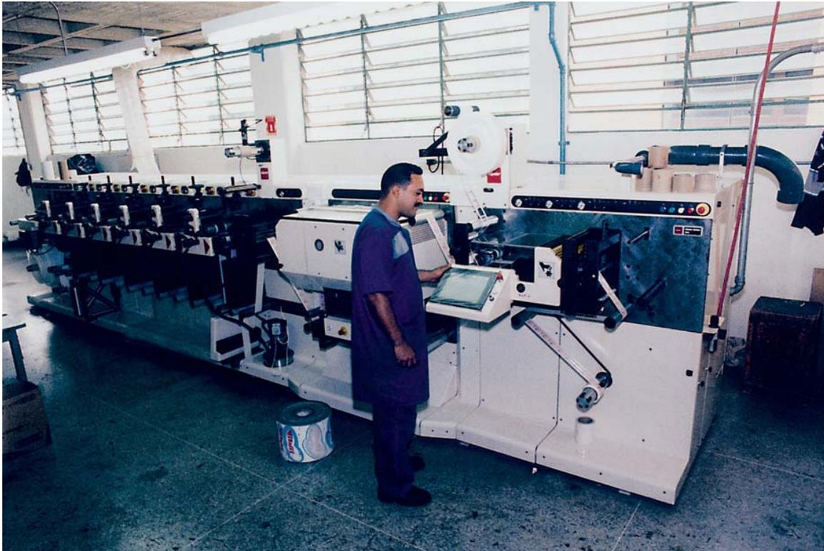
La prensa en línea tiene la versatilidad de imprimir sobre ambos lados de un rollo, ya sea invirtiendo la cinta con el sistema de inversión de barra o usando una forma de ensarte alternada. Estas prensas, también se pueden usar para recubrimiento por inmersión cuando se requiere el coloreado total de un material absorbente.
