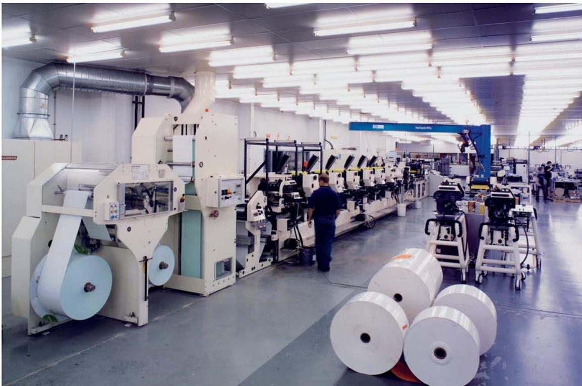
Las tintas son de secado rápido, prácticamente instantáneo. La tinta que se utiliza en rotograbado es muy líquida y contiene gran cantidad de disolvente, que se evapora rápidamente y deja el pigmento seco en el papel. Para acelerar el proceso de secado, la banda de papel, después de cada cuerpo, pasa por zonas de aire caliente o infrarrojo.
