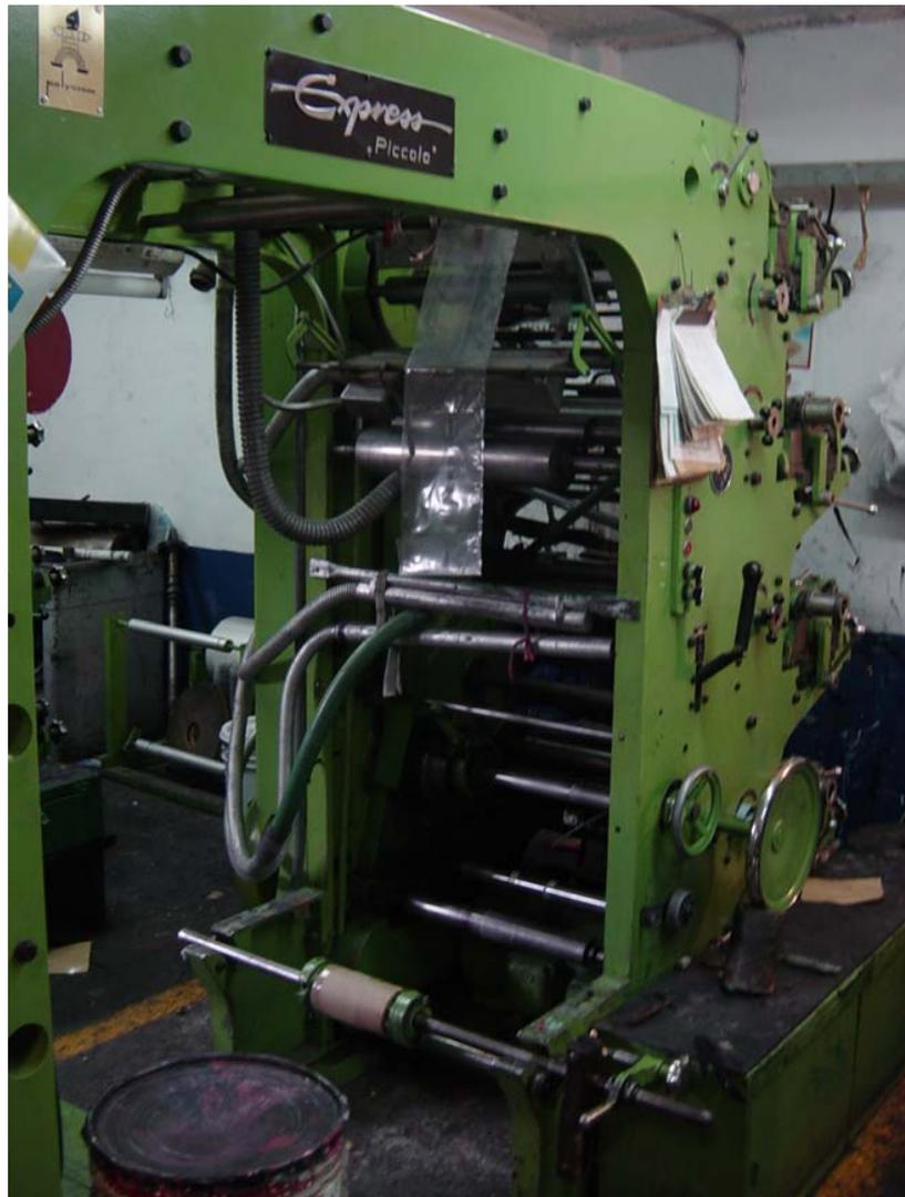
La prensa flexográfica tipo convencional se presta muy bien a otras aplicaciones específicas tales como impresión en línea con otro tipo de maquinaria. Estas pueden ser extrusoras, maquinas productoras de bolsas, cortadoras de hojas, laminadoras, etc.
