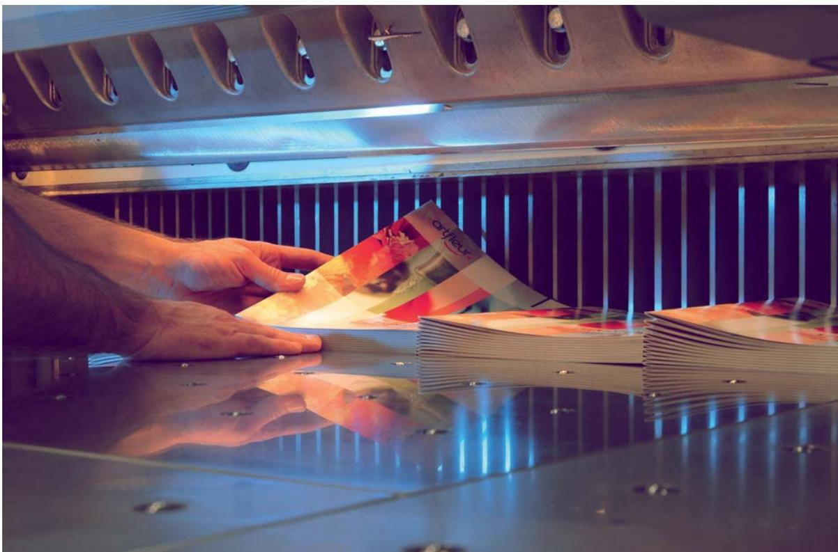
Este proceso se utiliza antes de entrar en máquina para acondicionar el papel para la impresión y finalizar un trabajo y dejarlo del tamaño indicado por las líneas de corte.
