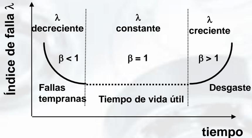
Las tres porciones de la curva de tina de la bañera tienen diferentes índices de falla. Las fallas tempranas se caracterizan por un índice de falla decreciente, la vida útil por un índice de falla constante y el desgaste se caracteriza por un índice de falla creciente. La distribución de Weibull puede modelar matemáticamente estas tres situaciones.
