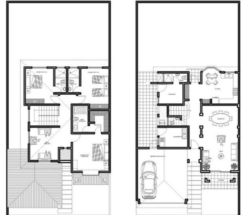
**Planta:** dibujo arquitectónico de un edificio representado en sección horizontal. Su importancia radica en que es la mejor representación de la disposición y distribución del espacio arquitectónico, así como de la particular articulación de sus elementos formales.
