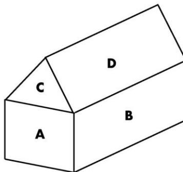
2. Genera el isométrico de la figura anterior utilizando la montea que has hecho en la primera actividad, recuerda usar la línea central a 90° grados y las demás a 30° grados para poder dibujarla con sus respectivas caras.
