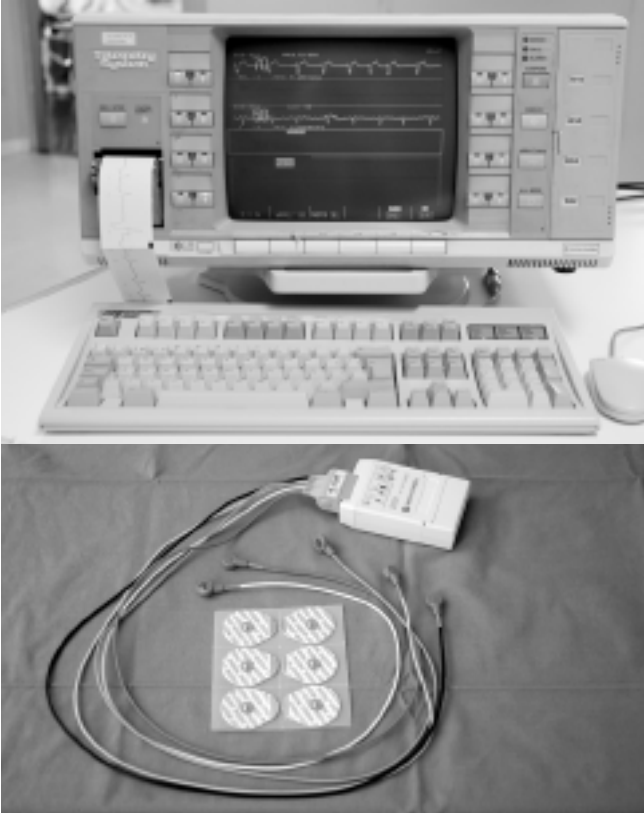
Monitor de telemetría y Radiotransmisor
