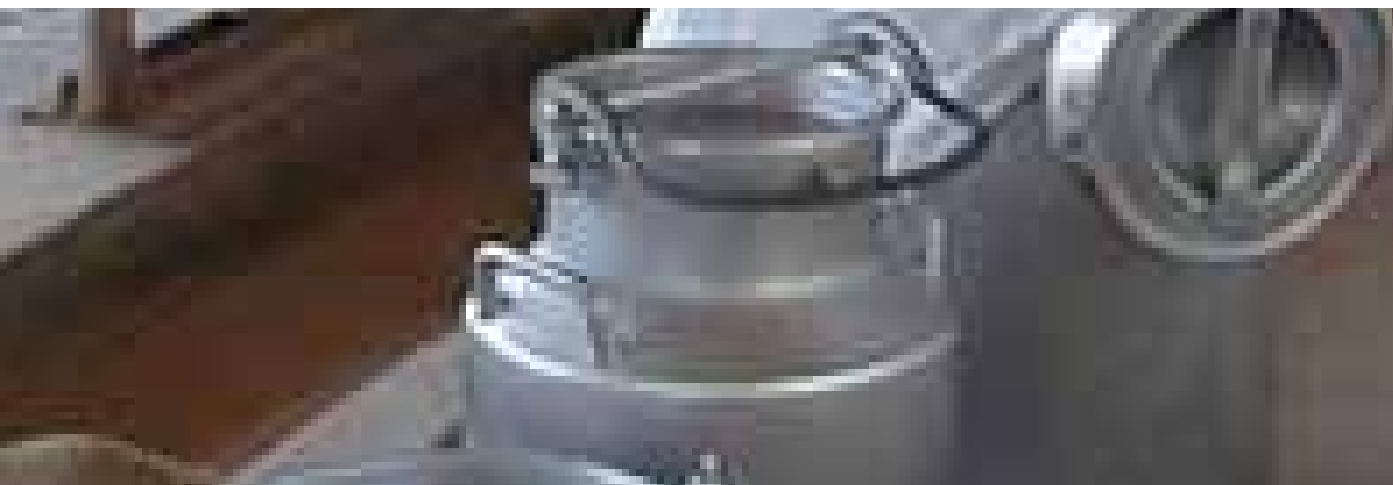
Los recipientes colectores y enfriadores de leche deben ser de una sola pieza y de acero inoxidable
