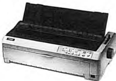
Una impresora de matriz de puntos crea una imagen al emplear un mecanismo llamado cabeza de impresión, el cual contiene un grupo (o *matriz*) de agujas cortas acomodadas en una o más columnas. Cuando recibe las instrucciones de la PC, la impresora puede empujar cualquiera de las agujas hacia delante en cualquier combinación. Al empujar las agujas en combinaciones distintas, la cabeza de impresión puede crear caracteres alfanuméricos (véase las figuras 4B.4 y 4B.5).
