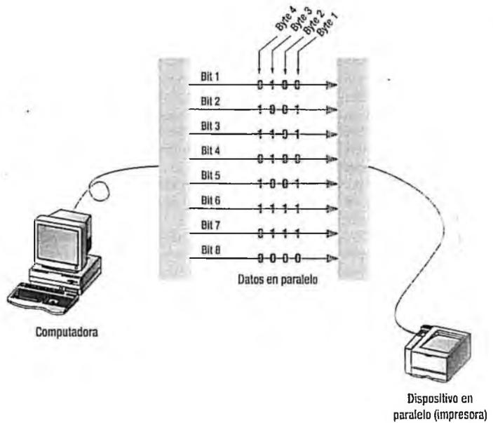
Como se imaginará, una interfaz paralela puede manejar un volumen de datos más grande que una interfaz serial, debido a que a través de una interfaz paralela puede transmitir más de un bit de datos simultáneamente. La figura 5B.10 muestra la manera en que transitan los datos a través de una interfaz paralela.
