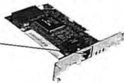
La tarjeta de interfaz de red acepta un cable de red, el cual conecta físicamente la computadora con la red.
