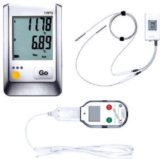
Fotografía 4.10. Dispositivos externos de medición de temperatura de ultracongelación.
