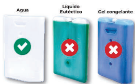
Fotografía 4.14. Contenido de los paquetes refrigerantes.
