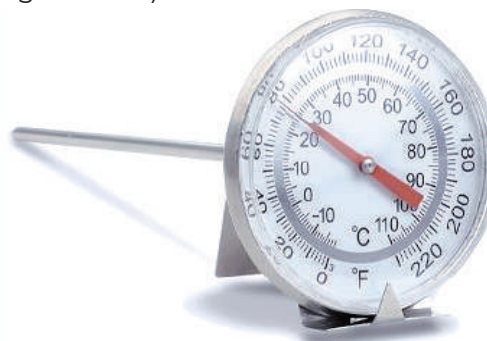
Fotografía 4.18. Termómetro de vástago con sensor de 20 a 30 cm de largo.
