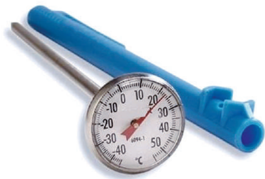
Fotografía 4.19. Termómetro de vástago con sensor de 14 cm de largo.
