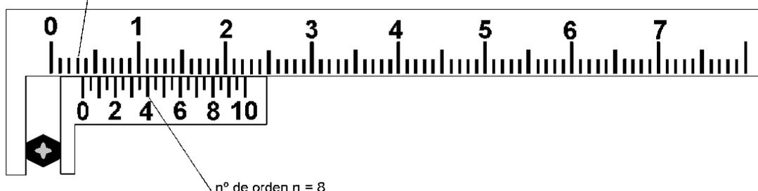
La apreciación del calibre es  $A = 1 \text{ mm}/20 = 0,05 \text{ mm}$ ,  $L_0 = 3 \text{ mm}$ ,  $n = 8$  por lo tanto el valor observado es:  $L' = 3 \text{ mm} + 8 \cdot 0,05 \text{ mm} = 3,40 \text{ mm}$ . Por lo tanto, si consideramos la existencia de incertezas solo debido a la apreciación,  $L = (3,40 \pm 0,05) \text{ mm}$
