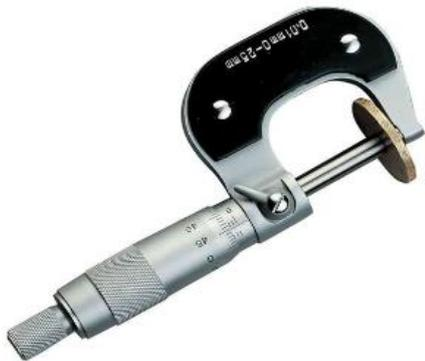
Este instrumento de medición, sirve para medir las dimensiones de un objeto con alta precisión del orden de centésimas de milímetros (0,01 mm) y de milésimas de milímetros (0,001 mm = 1  $\mu$ m, micrómetro o micra) y su fabricación se basa en la norma DIN 863.
