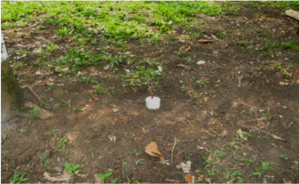
F3. Localización del vértice A de la poligonal de apoyo, sobre mojonera de concreto
