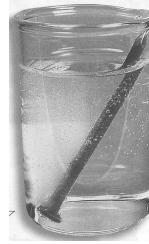
Fig. 1.18c Oxidación de un clavo de hierro. Phillips. P. 483
