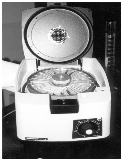
Fig. 1.25. Muestra una centrifuga de tubos capilares, empleada para análisis clínicos.
