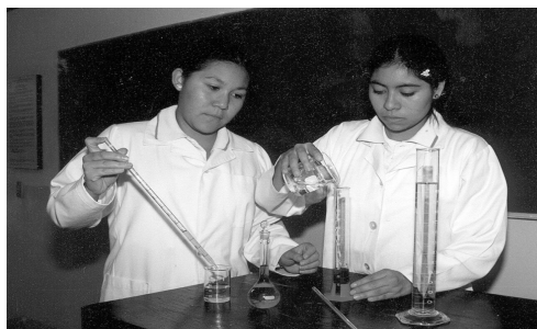
Fig 1.8. Medición de volúmenes, empleando probetas, pipetas y matraces aforados
