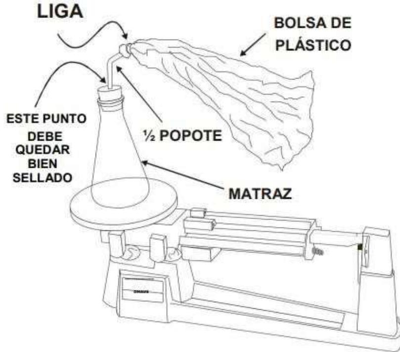
2.- Pesa el conjunto vacío y anota el dato: \_\_\_\_\_, pesa el matraz vacío y anota el dato: \_\_\_\_\_, pesa el matraz con ácido y anota el dato: \_\_\_\_\_.
