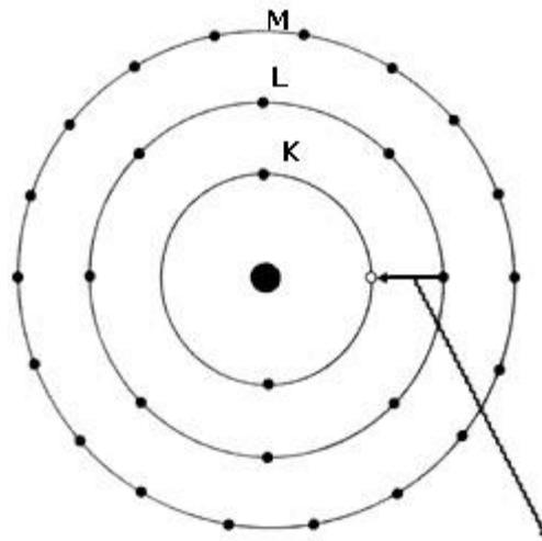
Figura 3. Si sucede una ionización en la capa K, un electrón de la capa L llena la vacancia, emitiéndose un fotón.
