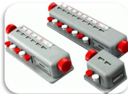
**Fig. 3.59. Contador Manual de Células**
