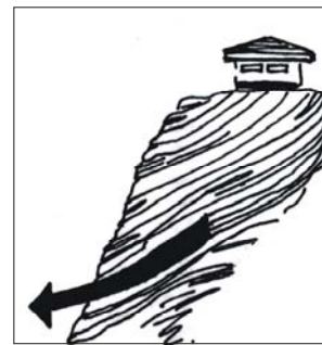
Talud de roca inestable.
