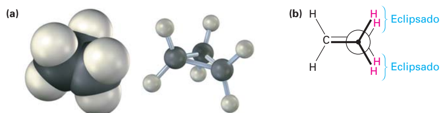
Figura 4.4 La estructura del ciclopropano muestra el eclipsamiento de los enlaces C–H vecinos que da un incremento en la tensión torsional. La parte (b) es una proyección de Newman a lo largo de un enlace C–C.
