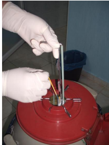
Figura 24. Extracción de una pajilla del tanque de nitrógeno (Fotografía cortesía de M. en C. Angélica Gil, 2012).
