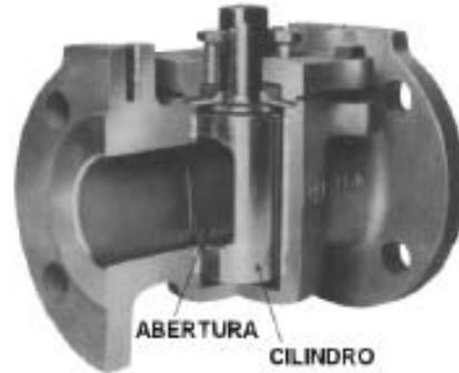
**Figura 2.15 Válvula de mariposa      Figura 2.16 Válvula de asiento (macho)**
