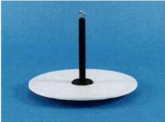
**Fig. 7 Disco de Secchi**
