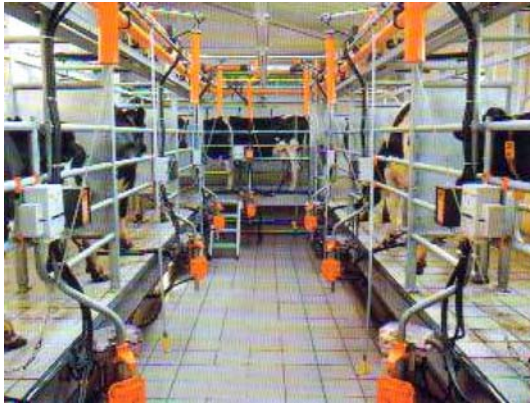
Sala tipo tándem y posible disposición de plazas. Fuente: Fullwood Milkingparlos, UK
