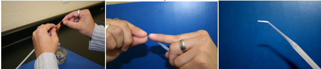
Figura64. Una vez realizado lo anterior, se acerca con mucho cuidado la punta de la pipeta a la flama del mechero (A); se aleja rápidamente y, como se puede apreciar en (B), se procede a apoyarse con los dedos para formar un ligero ángulo de 30°; de esta manera, la pipeta quedará como en se muestra en (C).
