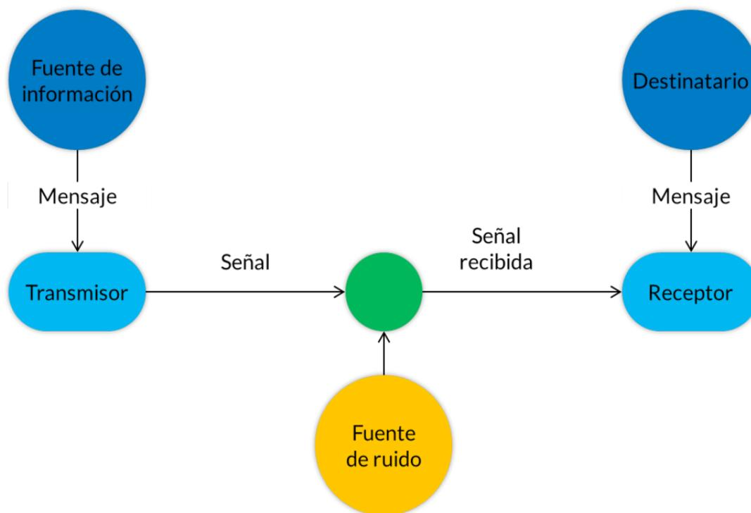
Figura 1.1 Modelo del proceso de comunicación.
