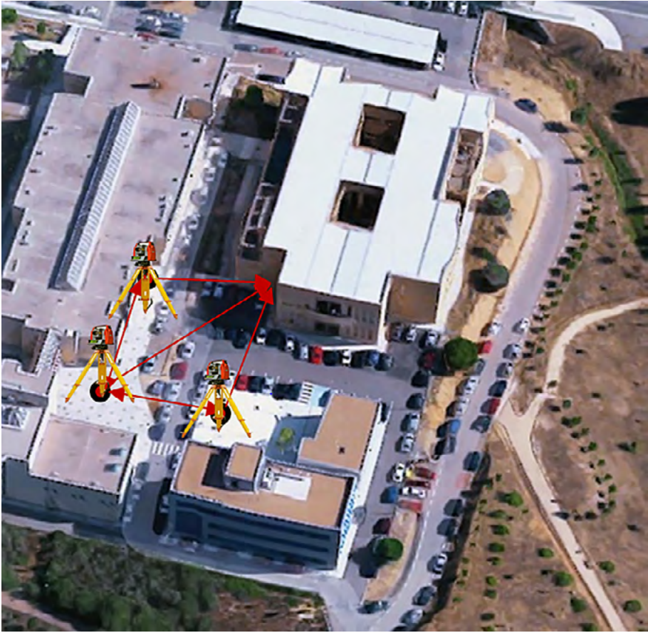
Figura 21. Intersección directa múltiple. Escuela Politécnica de Cáceres.
