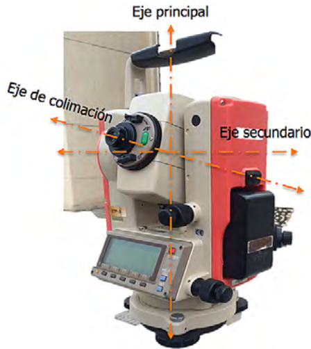
Figura 10. Ejes de una estación total (ET).
