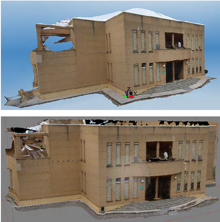
Figura 23. Fachada principal del edificio de Telecomunicaciones de la Escuela Politécnica de la UNEx. Imagen superior generada con 123Catch, imagen inferior con Agisoft PhotoScan (fuente: TFM de Daniel Almagro, septiembre de 2016).
