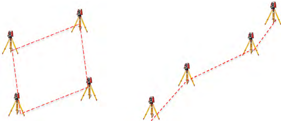
Figura 21. Tipos de poligonales: Cerrada (poligonal izquierda) y abierta (poligonal derecha).
