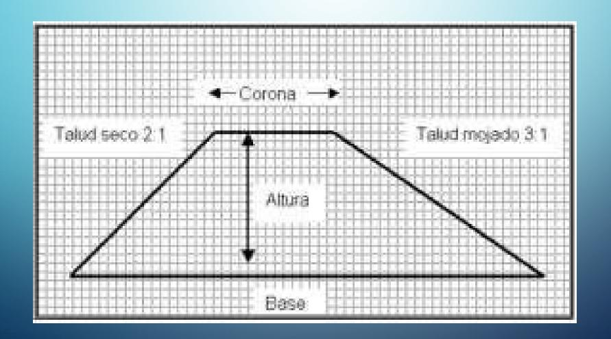
• Siembra de césped sobre la corona y talud seco. Es conveniente sembrar césped sobre la corona y el lado seco del dique (talud exterior). La vegetación ayudará a evitar la erosión del suelo
